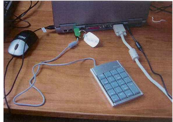
Abb. 6: Die Probanden antworteten mit Hilfe dieser zusätzlich an das Notebook angebrachten numerischen Tastatur (Targus USB Mini Keypad).
