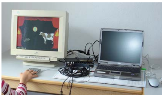
Abb. 1: Geräteaufbau: Das Notebook Dell Latitude D610 als zentrales Element, an welches ein externer Monitor (ADI Modiscan) angeschlossen ist. Die Hammerfall DSP Multiface Soundbox, sowie die beiden Kopfhörer und die numerische Tastatur sind ebenfalls miteinander verbunden.
