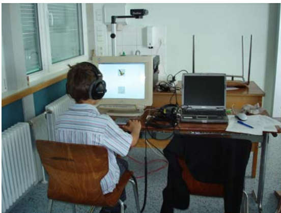
Abb. 10: Messsituation und Monitordarstellung bei der Tonschwellenmessung (die Versuchsleiterin saß rechts neben dem Probanden). Das Kind antwortete per Tatendruck auf der zusätzlich angebrachten numerischen Tastatur.
