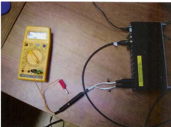
Abb. 7: Die Kalibrierung der Hammerfall Soundbox erfolgte mit Hilfe eines Multimeters zur Spannungsmessung.
